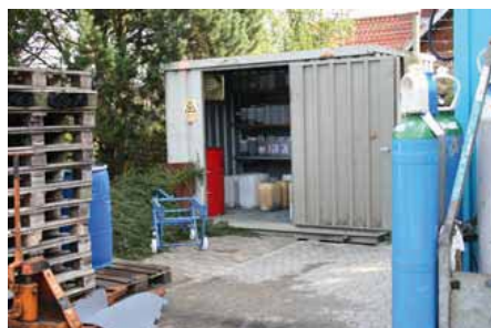
Miljøcontainer med indbygget spildbakke til udendørs opbevaring af farligt affald og farlige råvarer og produkter.
