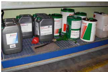
Råvareoplag stillet på reol med kar til opsamling af evt. spild og lækager.
