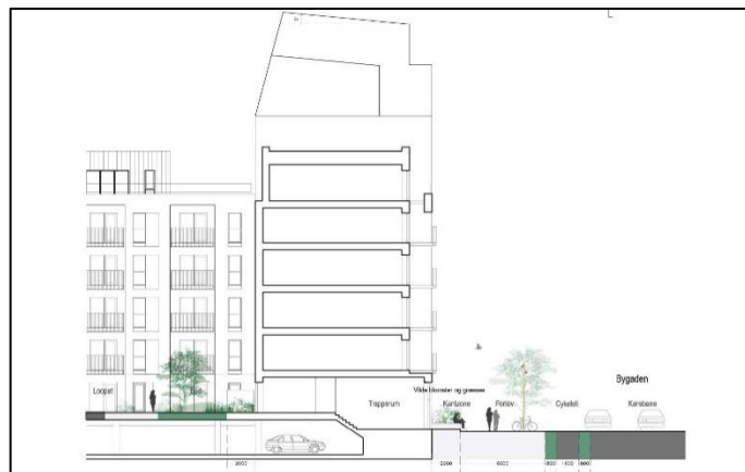
Figur 19: Eksempel på hvordan tårnbebyggelserne udformes med en skrå profil, der mod gårdrummet spænder over de to øverste etager.
