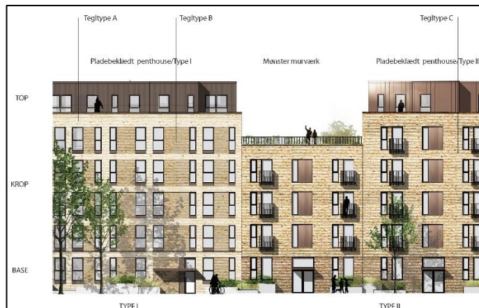
Figur 16: Eksempel på inddeling af facader i base, krop og top samt facadetypologi 1 og 2 og tagterrasse på bebyggelse i 5 etager. Se større version på bilag 8.
