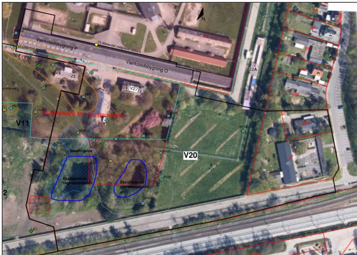
Figur 1: Oversigtskort over V20 (kilde: Baggrundskort fra arealinformation.dk). Fanen med klorerede opløsningsmidler er markeret med grå streg. Fanen med klorerede opløsningsmidler over kvalitetskriterierne er markeret med orange streg.
