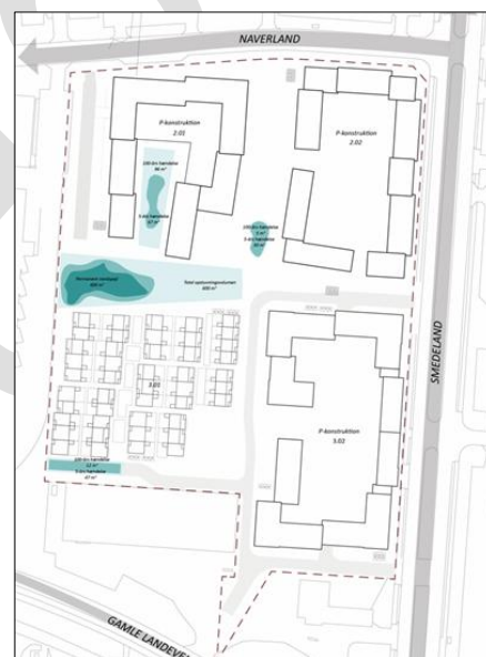
Figur 31: Forslag til fremtidig opmagasinering af 5-års og 100-års regnhændelse.
