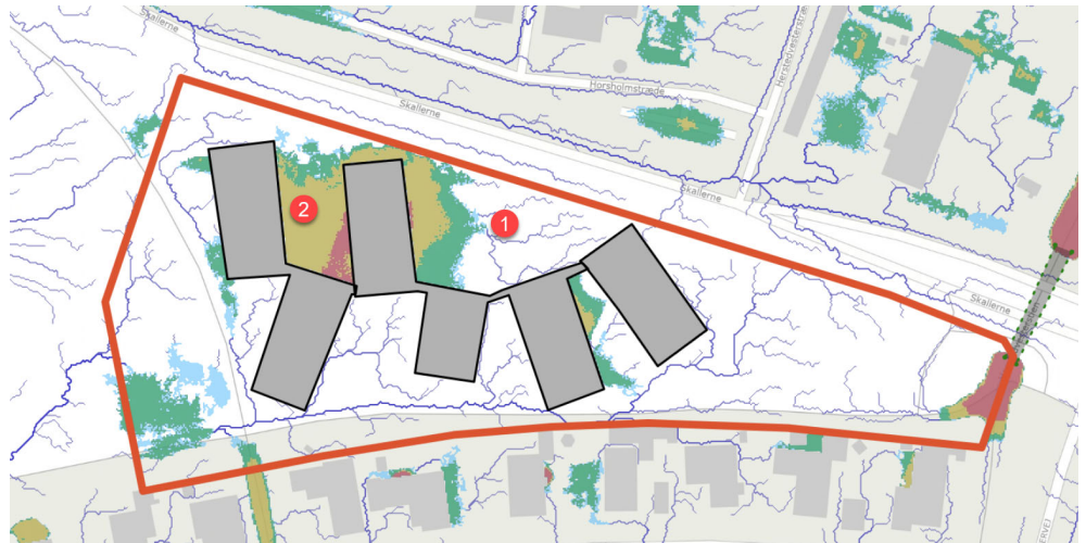
Figur 13 Analyse med fremtidige bygninger i terrænmodel. Vanddybde: Grøn: 0-10 cm; Gul 10-30 cm; Rød over 30 cm
