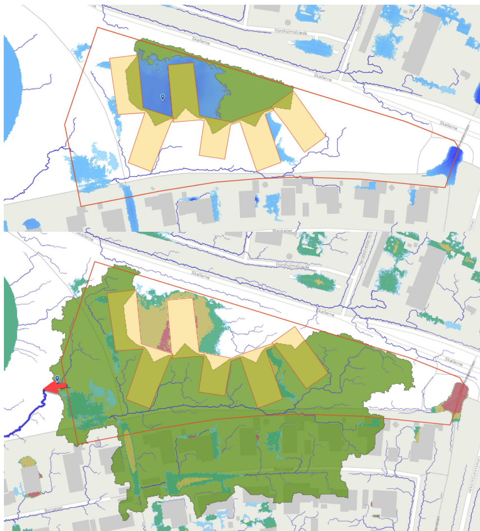
Figur 14 Afstrømningsoplande - analyse med fremtidige bygninger. Øverst opland til samling af vand ved bygninger, nederst opland til udløbspunktet mod vest
