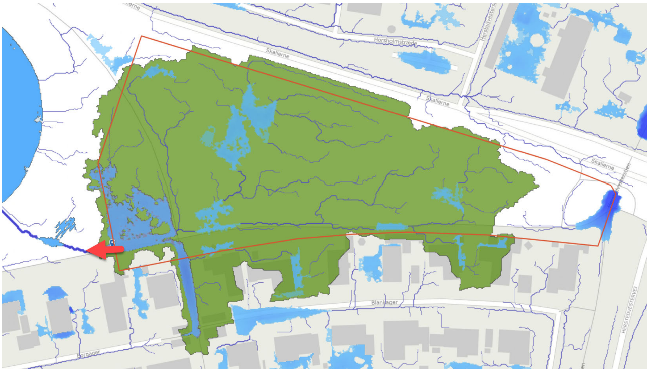
Figur 10 Strømningsveje og lavninger samt afstrømningsopland. Strømning ud af matriklen er angivet med pil mod vest.
