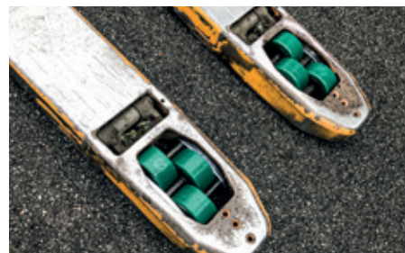
3 hjul i stedet for 1 hjul gør, at kørsel over ujævn overflade ikke støjer.
