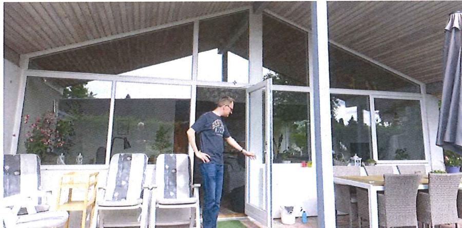
Steffen og familie fra Kongsager besøgte Varmens Dag i 2016 og bestilte et energitjek. Så blev taget efterisolering, hulmursisoleringen suppleret og den store kolde glasgavl udskiftet til trelags med 30% varmetab i forhold til før. Et eksempel på opmærksomme borgere, lokal kommunikation, et væsentligt energitilskud, kvalificeret energivejledning - og deraf handling.
