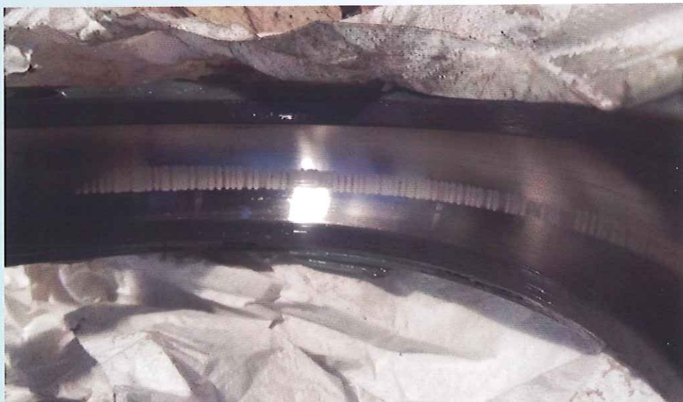
Tydelige slidspor i kuglelejet som følge af elektrisk støj.
