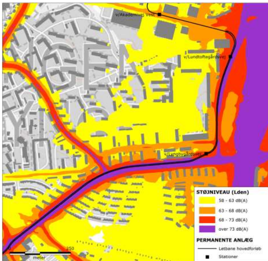
Figur 6.1 | Støjkort for o-alternativ for den ændrede linjeføring i Lyngby-Taarbæk Kommune. Samlet støj fra jernbane og veje.
