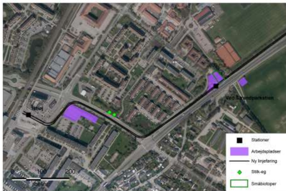
Figur 8.1 | Ændret linjeføring langs Ishøj Strandvej og Ishøj stationsvej med placering af egetræer.
