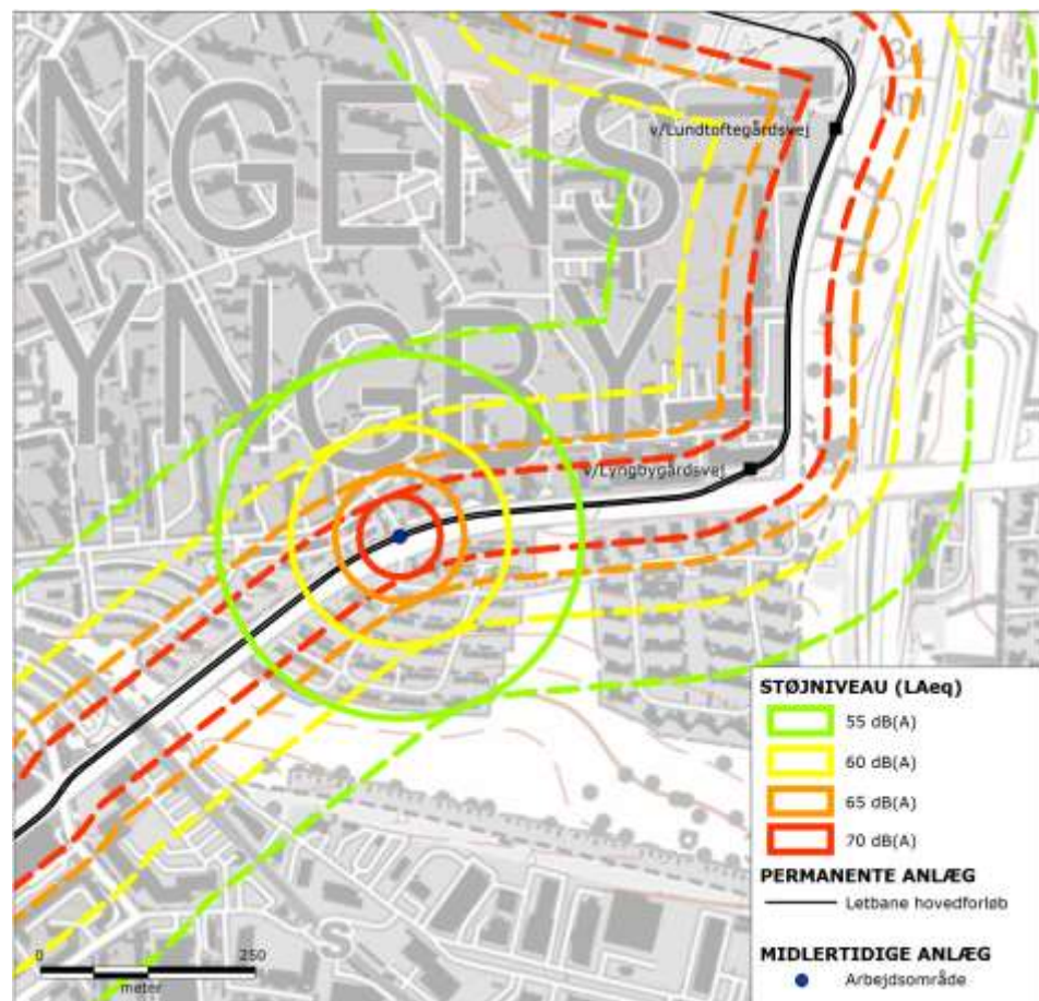
Figur 6.7 | Støj fra etablering af letbanespor for den ændrede linjeføring i del af Lyngby-Taarbæk Kommune.
