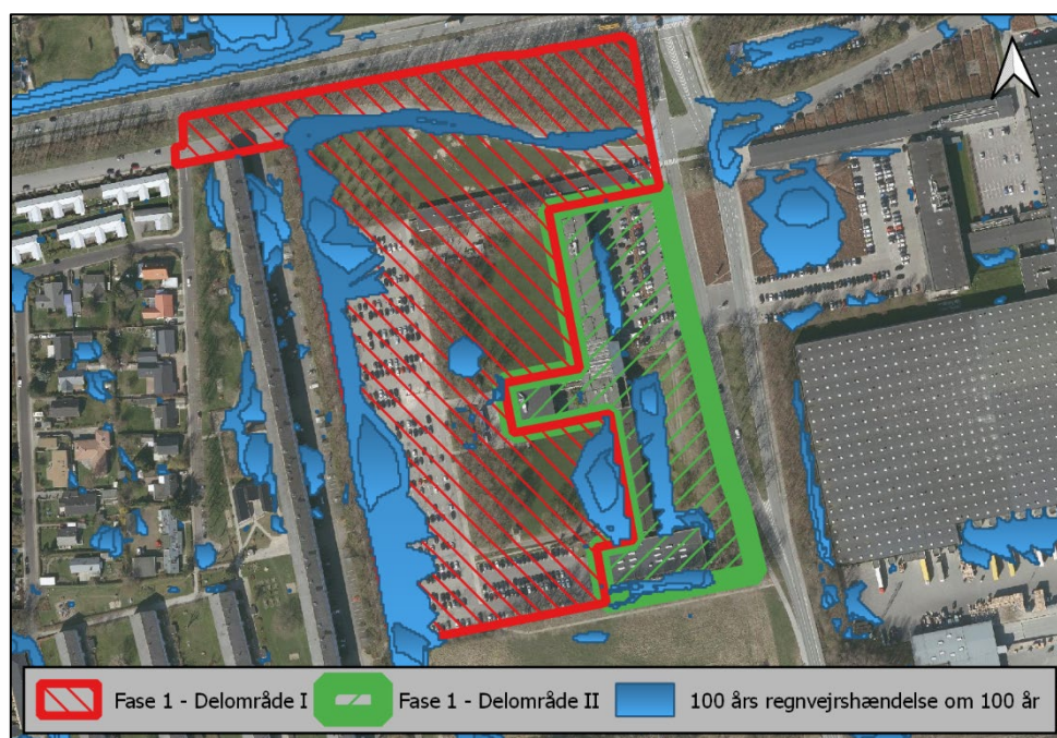
Figur 6: Oversigtskort der viser, hvor regnvandet vil ophobe sig ved en 100 års regnvejrhændelse om 100 år.
