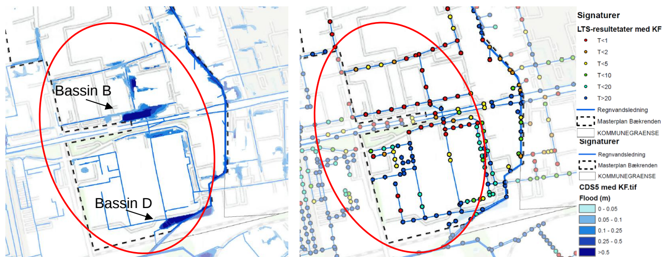
Figur 1 - Udfordringer i statussituationen. Til venstre: resultat af oversvømmelsesberegning, CDS 5 i fremtidigt klima. Til højre: resultat af LTS-beregning i fremtidigt klima. Projektafgrænsning er vist med rød streg.
