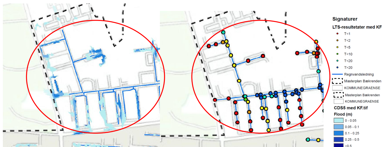
Figur 14 - Udfordringer i statussituationen. Til venstre: resultat af oversvømmelsesberegning, CDS 5 i fremtidigt klima. Til højre: resultat af LTS-beregning i fremtidigt klima. Projektafgrænsning er vist med rød streg.
