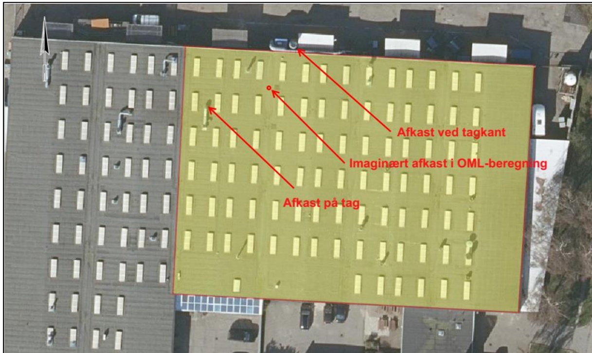
Figur 3.3: Afkast hos Hougaard & Koefoed. Det imaginære afkast forudsættes at være 5,7 m højt.
