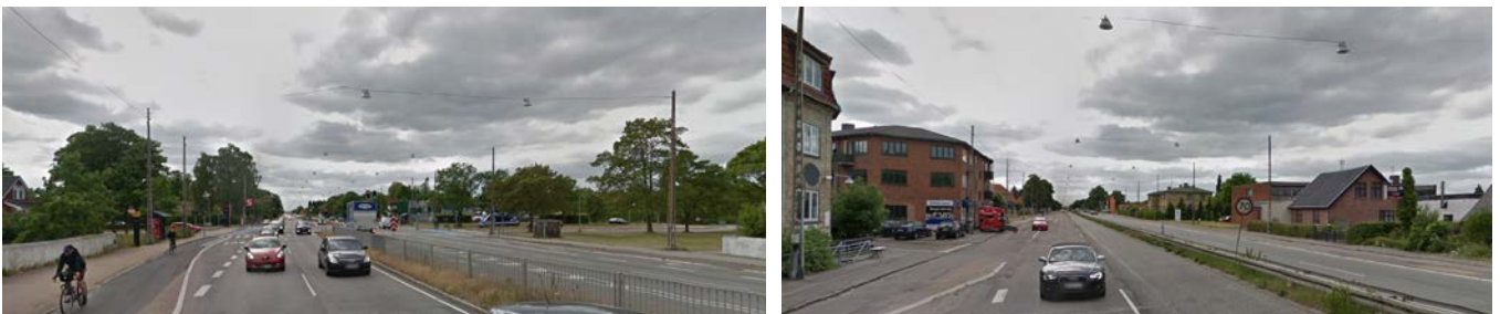
Figur 14: Billedet t.v. er fra krydset Albertslundvej/Damgårdvej. Det store åbne vejrum, hvor bygninger og træer står mere spredt (fremfor langs vejkanterne), understøtter ikke trafikorienteringen i krydset. Autoværnene giver vejen et mere funktionsbestemt end visuelt indbydende udtryk.
