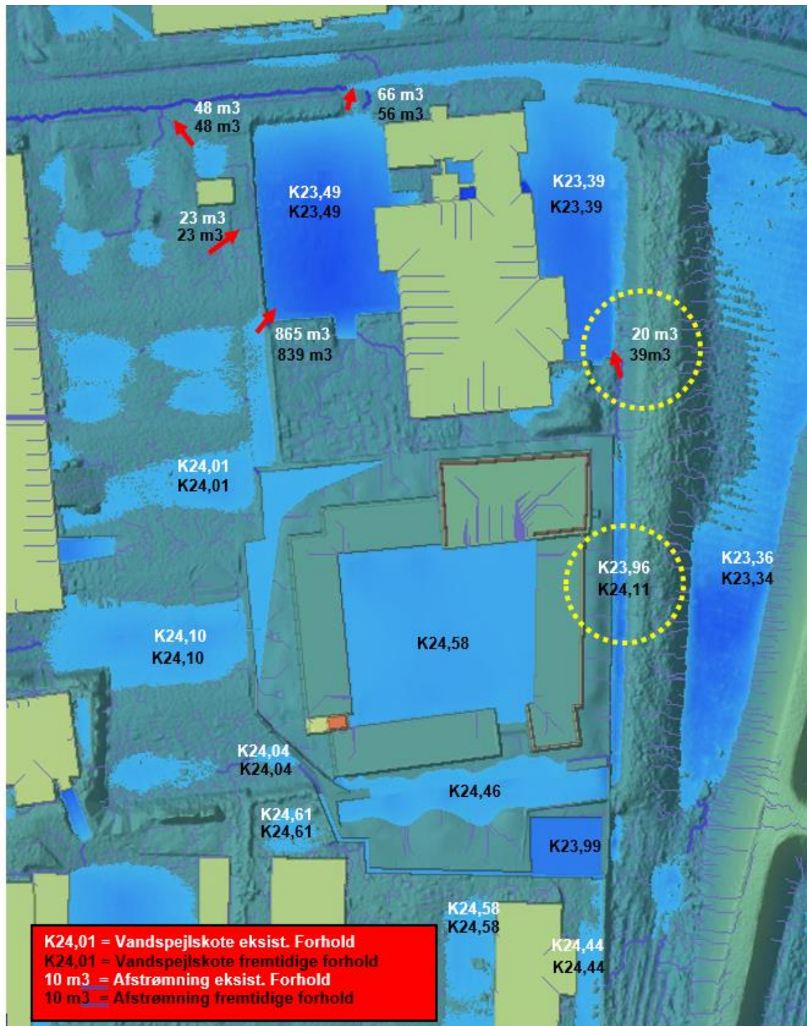
Figur 7 Vandspejlskoter og strømning på terræn under hhv. eksisterende og fremtidige forhold v. 100 års-hændelse. røde pile = strømningsretning. Områder hvor der ved fremtidige forhold opstaves/afstrømmer mere vand end ved eksisterende forhold, er markeret med gule cirkler.
