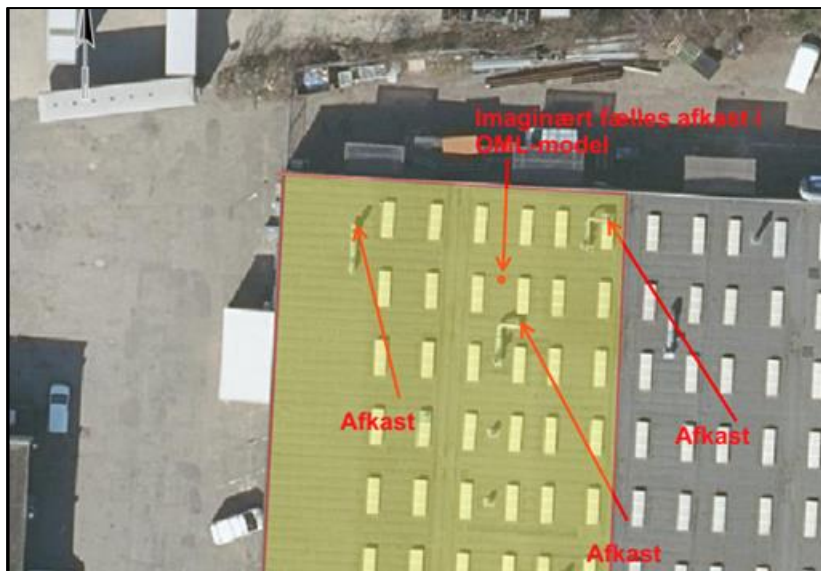
Figur 5: Afkast hos JS Ventilation og placering af imaginært afkast til spredningsberegning.
