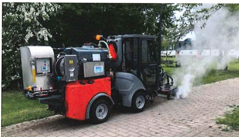
Ukrudtsbekæmpelse med vanddamp i Syd
