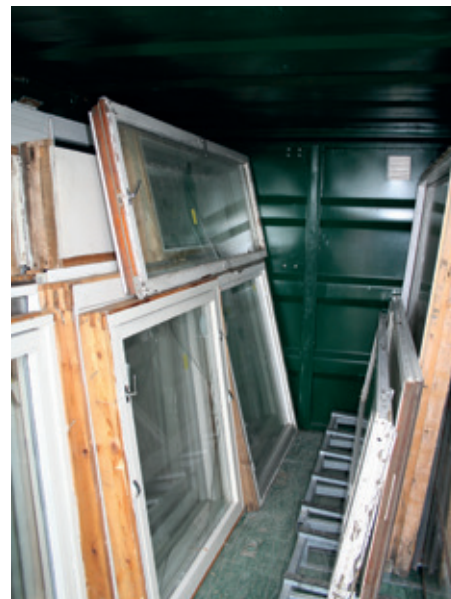
Vinduer med PCB-holdige termoruder fra renovering.
