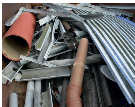
Frasorteret hårdt PVC affald til genbrug. Blødt PVC deponeres.
