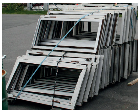
Vinduesrammer forurenede med PCB fra monterede PCB-holdige termoruder. Skal som udgangspunkt bortskaffes som farligt affald.
