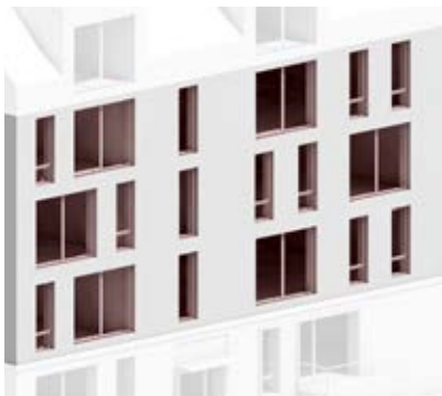
Vinduer med skift i vinduessætning, hvor vinduer bytter plads fra etage til etage jf. § 6
