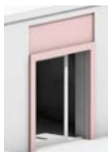
Indgangsparti med detaljering omkring indgangsparti jf. § 6. Her vist med muret rulleskifte eller opmuret udadgående reces
