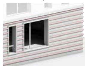
Detaljerings ved gennemgående horisontalt motiv der giver reliefvirkning jf. § 6. Her vist som muret recesforbandt
