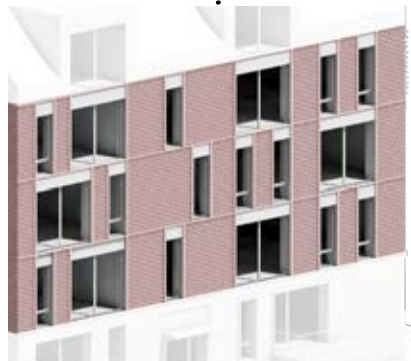
Skift i retning/dybde på facademateriale jf. § 6
